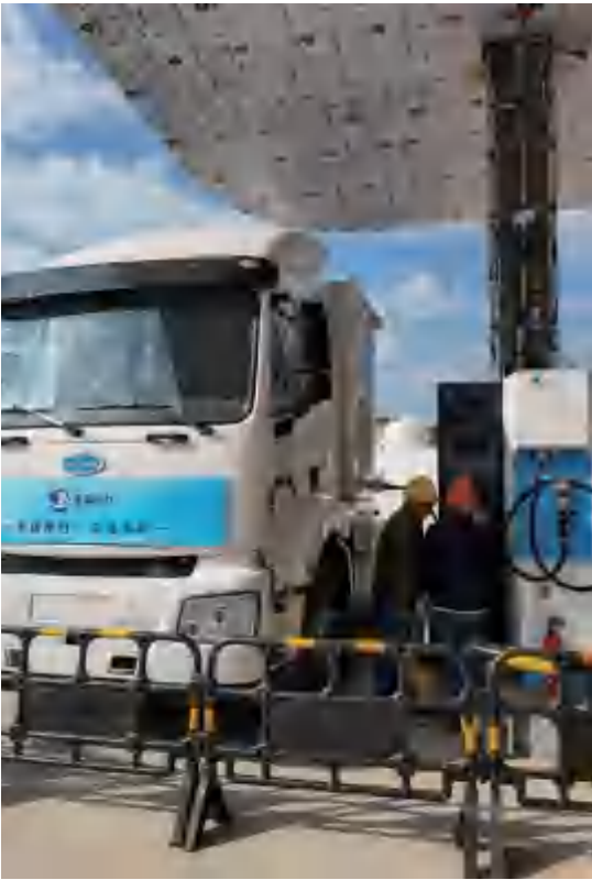
妈湾电厂制氢加氢一体站氢能重卡加氢试验
